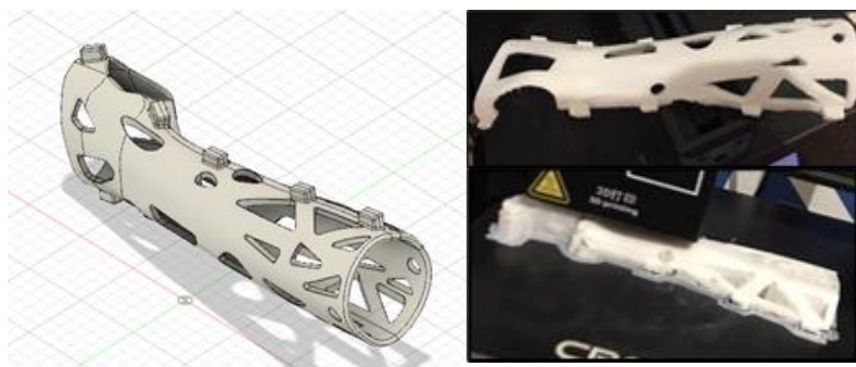
Figura 7. Diseño optimizado de la ortesis.
