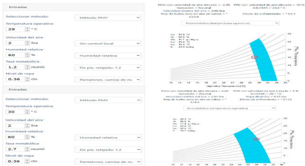
Figura 1. Datos de la evaluación en el interior de la vivienda 1.
