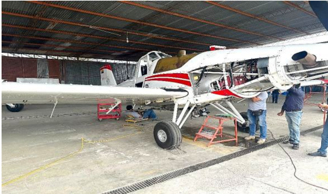
Figura 9. Vista general de una aeronave Thrusch S2R-T34 durante la inspección de 100 horas en el hangar.
