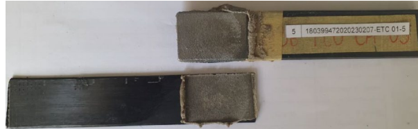
Figura 11. Fallas adhesivas, se produjo en muestras con limpieza superficial por disco de cerdas.
