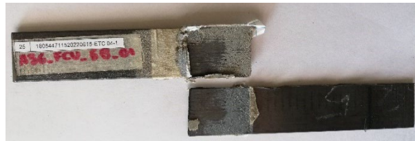
Figura 10. Falla adherencia/cohesión, se produjeron en las muestras con limpieza superficial por granallado.
