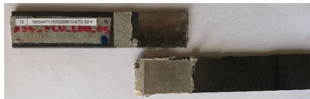
Figura 9. Fallas de adherencia, se produjeron en probetas con limpieza superficial: manual, disco abrasivo, disco de lija.
