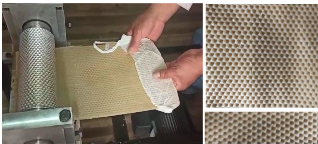
Figura 6. Laminación de cera de abeja con patrón alveolado de 1 mm.
