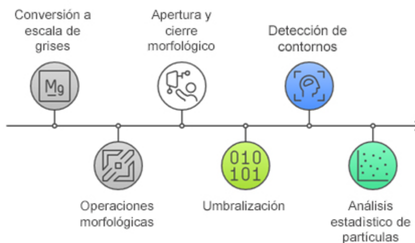
Figura 4. Proceso de análisis para una imagen.
