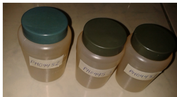
Figura 3. Muestras de solución mucilaginosa obtenido a partir de cáscaras de cacao nacional para determinar viscosidad.
