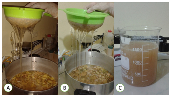
Figura 2. Tamizado de la solución mucilaginosa (C) obtenido a partir de cáscaras de cacao nacional maduro (A) y pintón (B).
